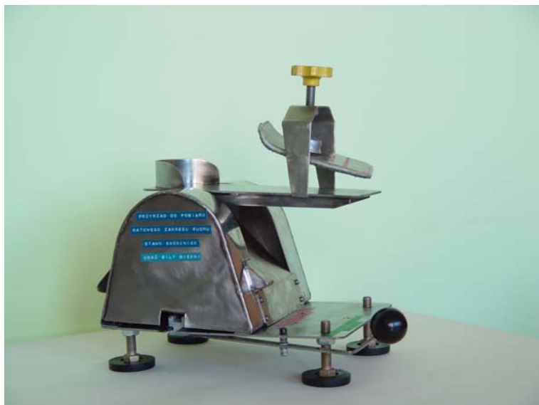
RYS. 5 Stanowisko badawcze do oceny sprawności stawu skokowego FIG. 5. Test stand for diagnosing of ankle joint efficiency
