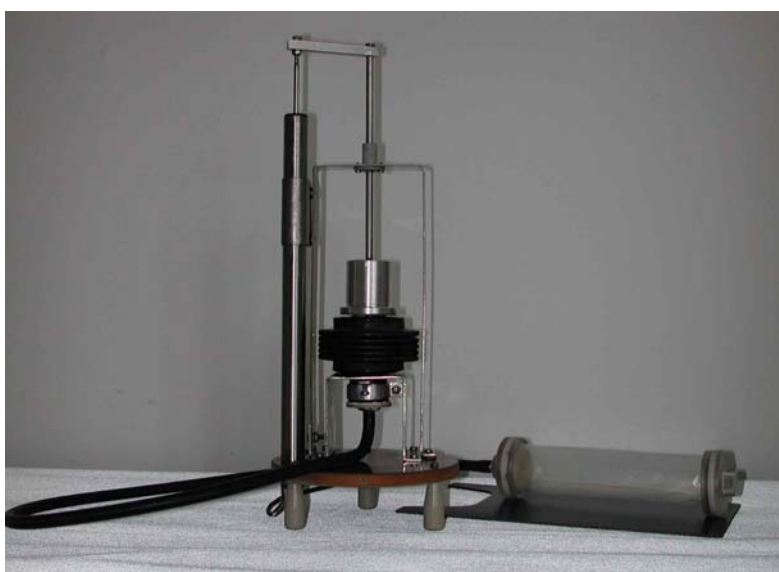
RYS. 3. Urządzenie do pomiaru zakresu ruchu ręki FIG. 3. Hand motion range measurement device
