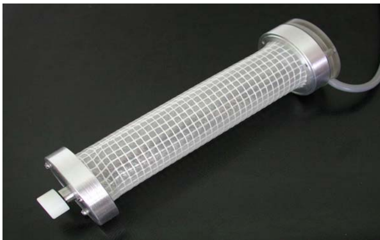
RES. 4. Urządzenie do pomiaru siły ścisku ręki FIG. 4. Hand clamping measurement device
