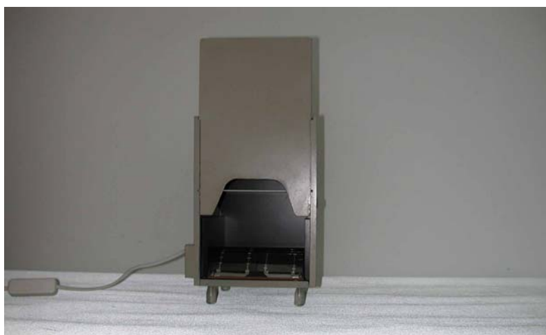
RYS. 2. Urządzenie do pomiaru powierzchni dłoniowej ręki FIG. 2. Hand surface measurement device
